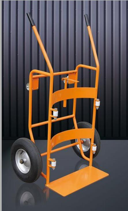
Handwagen zum Transportieren von Sicken-Fässern mit luftgefüllten Reifen. Die Fässer liegen bündig in den gerundeten Halterungen auf und werden zusätzlich von vier Rollen aus Polyamid gestützt. Der Stützbügel ist zusätzlich mit zwei kleinen Vollgummirädern versehen. So kann das Fass auch liegend geschoben werden. Mit handfreundlichen Gummigriffen.
